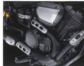
**Bicilindrico a V con iniezione elettronica.**
