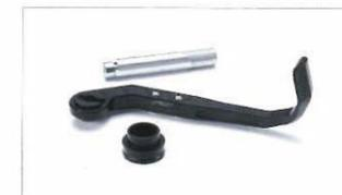
Protezione della leva del freno anteriore.
